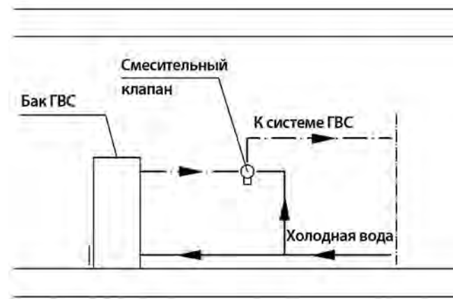
Рис. 5.8. Схема подключения термостатического смесительного клапана к системе ГВС многоквартирного жилого здания [10]
