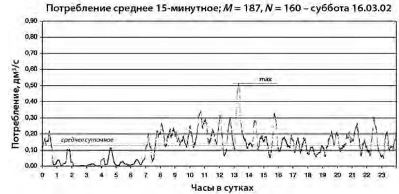
Рис. 2.6. 15-минутная динамика потребления в выходной день – субботу. Горизонтальной прерывистой линией обозначено потребление максимальное 15-минутное \dot{V}_{15\text{min}}^{\text{max}}
