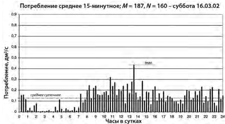
Рис. 2.5. Столбчатая 15-минутная гистограмма суточного потребления в выходной день – субботу. Горизонтальной прерывистой линией обозначено потребление максимальное 15-минутное \dot{V}_{15\text{min}}^{\text{max}}
