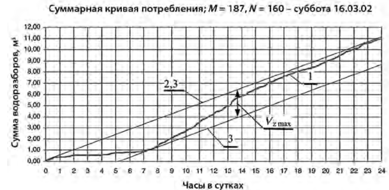
Рис. 2.13. Суммарная кривая потребления горячей воды с указанием емкости бака-аккумулятора, выходной день – суббота
