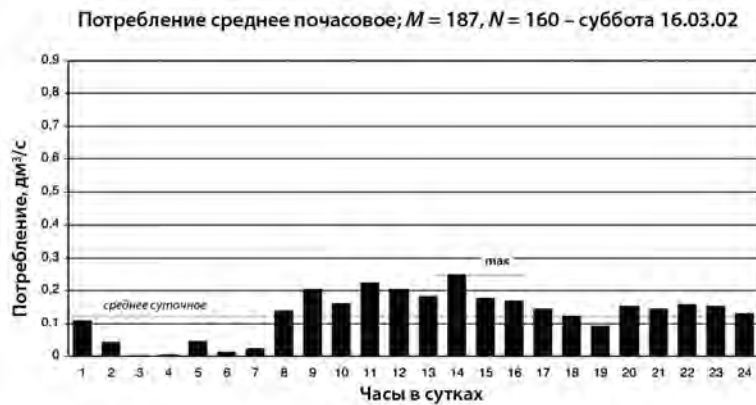
Рис. 2.9. Столбчатая гистограмма часового потребления в течение суток, в выходной день – субботу. Горизонтальной прерывистой линией обозначено максимальное часовое потребление \dot{V}_{godz}^{max}
