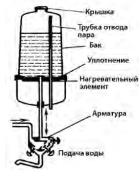
Рис. 10.6. Разрез кипятильника (водоподогревателя) для приготовления воды [8]
