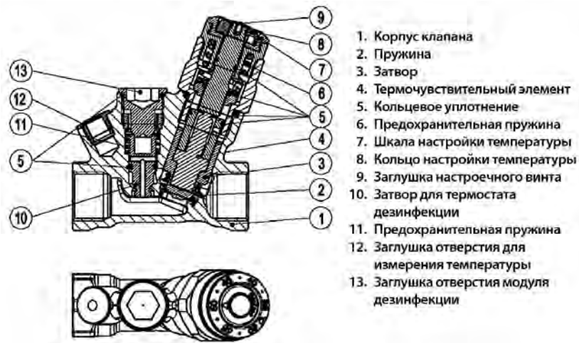
Рис. 5.4.а. Устройство термостатического циркуляционного клапана MTCV [1] – базовая версия В
