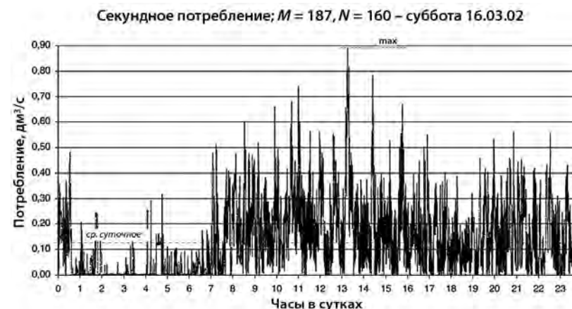
Рис. 2.2. Гистограмма суточного потребления воды в выходной день – субботу. Горизонтальной прерывистой линией обозначено максимальное секундное потребление \dot{V}_{chw}^{max}
