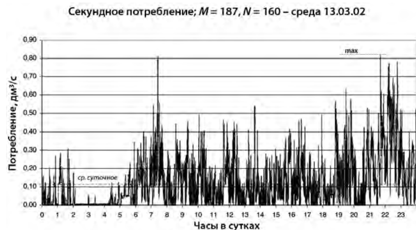
Рис. 2.1. Гистограмма суточного потребления воды в рабочий день – среду. Горизонтальной прерывистой линией обозначено максимальное секундное потребление \dot{V}_{chw}^{max}
