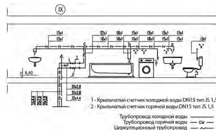
Рис. П.2. Детальная схема системы горячего и холодного водоснабжения
