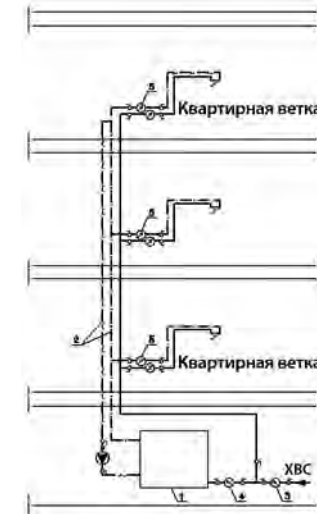
Рис. 9.1. Схема центральной системы ГВС многоквартирного жилого здания:
