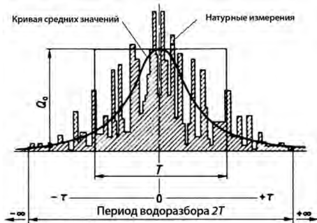
Рис. 2.18. Пример среднего расхода тепловой энергии на подогрев горячей воды в многоквартирном жилом здании [8; 11]
