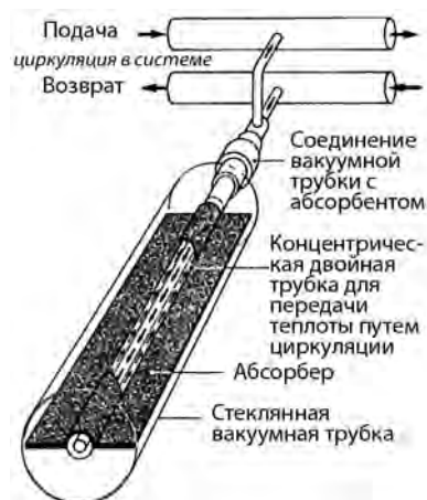
Рис. 13.5. Схема вакуумного коллектора [5]
