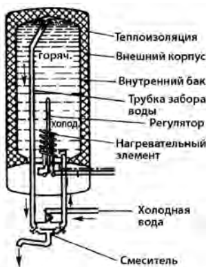
Рис. 10.5. Схема накопительного водоподогревателя [8]
