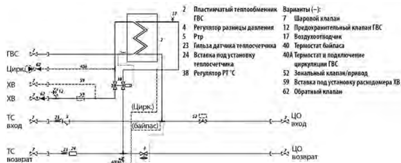
Рис. 10.12. Схема КТП для отопления и горячего водоснабжения [10]
