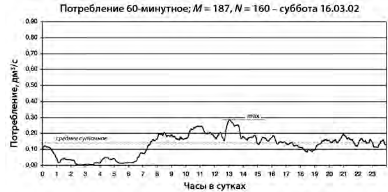
Рис. 2.10. Почасовая динамика потребления в выходной день – субботу. Горизонтальной прерывистой линией обозначено максимальное часовое потребление \dot{V}_{godz}^{max}
