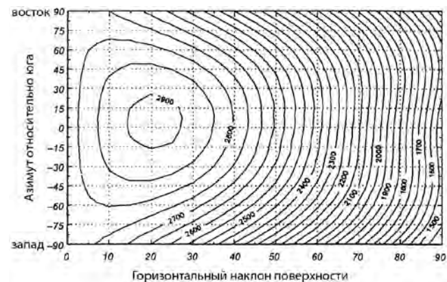
Рис. 13.12. Суммарное излучение (прямое и рассеянное, без учета отраженного) (апрель-сентябрь, регион Варшавы) [МДж/м²] для произвольно расположенной поверхности [2]
