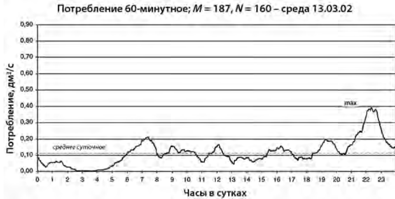
Рис. 2.8. Почасовая динамика потребления в рабочий день – среду. Горизонтальной прерывистой линией обозначено максимальное часовое потребление \dot{V}_{godz}^{max}
