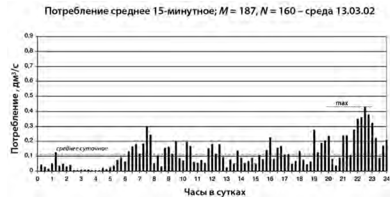
Рис. 2.3. Столбчатая 15-минутная гистограмма суточного потребления в рабочий день – среду. Горизонтальной прерывистой линией обозначено потребление максимальное 15-минутное \dot{V}_{15min}^{max}
